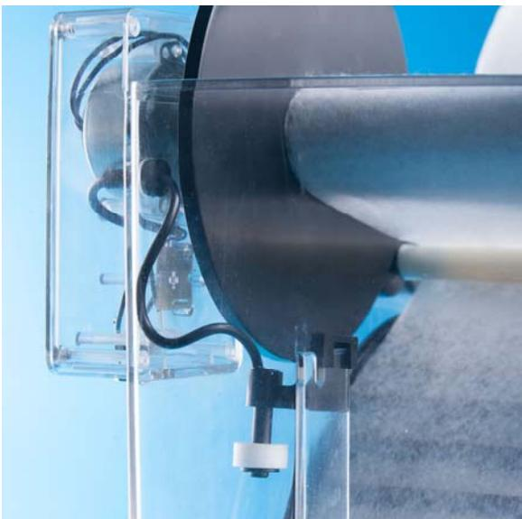
Das Vlies ist so fein, dass selbst sehr feine Verunreinigungen herausfiltriert werden. Dadurch wird der Schmutz aus dem Aquarium entfernt bevor er biologisch abgebaut wird. Das entlastet den Biofilter und im Meerwasser den Eiweißabschäumer.
